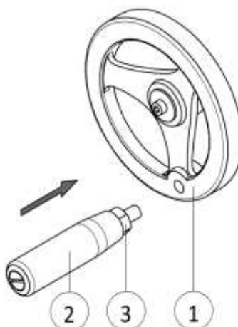
Рисунок 4 – Установка рукоятки 1 – Маховик, 2 – Рукоятка, 3 – Гайка
