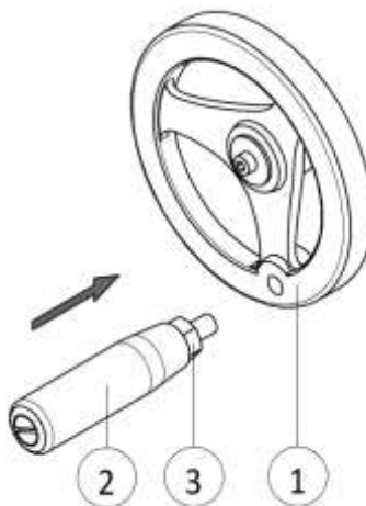
Рисунок 4 – Установка рукоятки 1 – Маховик, 2 – Рукоятка, 3 – Гайка
