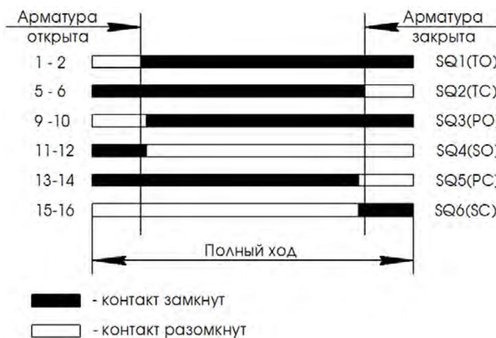
Примечание. На электрических схемах концевые выключатели показаны в состоянии, соответствующем среднему положению арматуры, моментные выключатели (только для ГЗ-ОФВ (М)) в состоянии, когда отсутствует перегрузка по крутящему моменту
