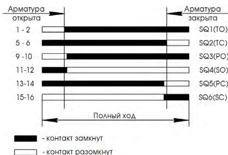
Примечание. На электрических схемах концевые выключатели показаны в состоянии, соответствующем среднему положению арматуры, моментные выключатели (только для ГЗ-ОФ (М)) в состоянии, когда отсутствует перегрузка по крутящему момент
